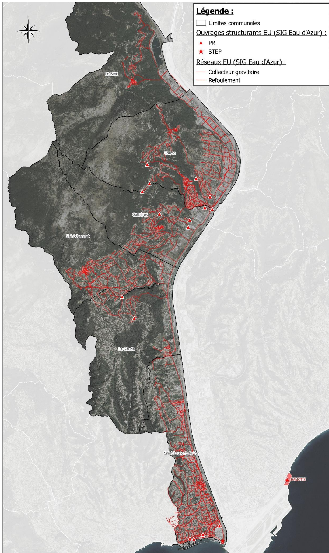
Figure 24 : Localisation des PR sur le réseau EU de Saint Laurent du Var (d'après SIG MNCA – extraction de décembre 2022)
