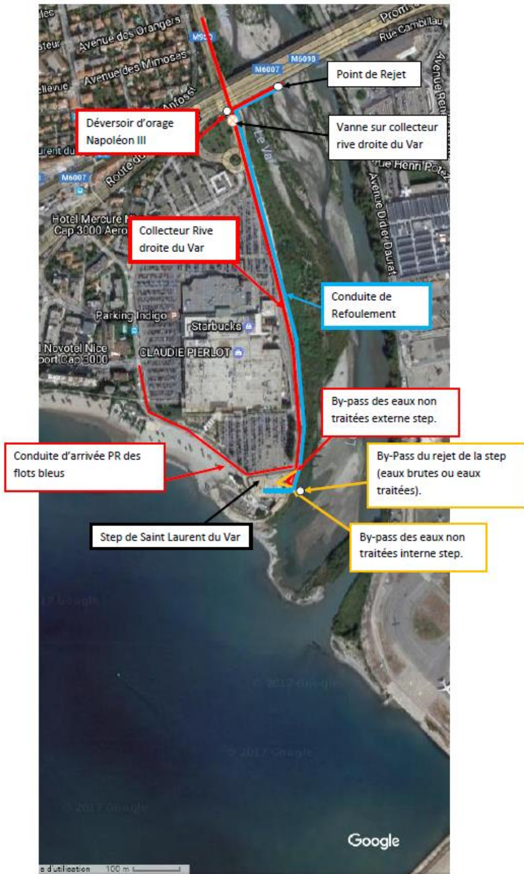
Figure 17 : Schéma de fonctionnement de la STEP de Saint Laurent du Var et des collecteurs associés (source : MNCA, 2022)
